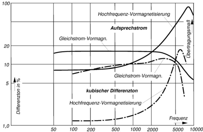
Fig. 4: Frequency response of recording amplifier and spectra of distortions at DC bias ("Gleichstrom-Vormagnetisierung") und AC bias ("Hochfrequenz-Vormagnetisierung")
