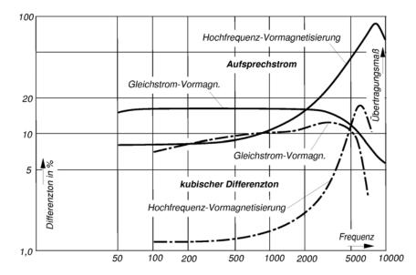
Fig. 4: Frequency repsonse of recording amplifier and spektra of distorsions at DC bias ("Gleichstrom-Vormagnetisierung") und AC bias ("Hochfrequenz-Vormagnetisierung")
